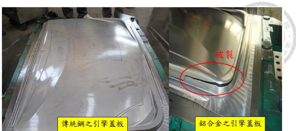
圖 2.9 鋁合金與傳統鋼引擎蓋板之成形差異[31]
