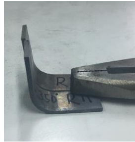
圖 5.43 A6061-T6 在 150 度與 350 度之 V 型彎曲溫成形結果
