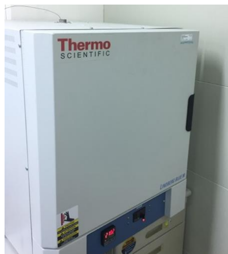
圖 5. 35 加熱爐與熱電偶量測板材升溫曲線
