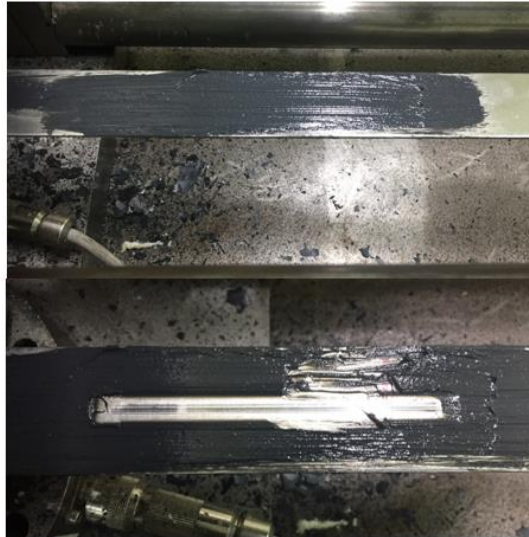
圖 2.48 二硫化鉬潤滑劑條件下之鋁材摩擦前後對照
