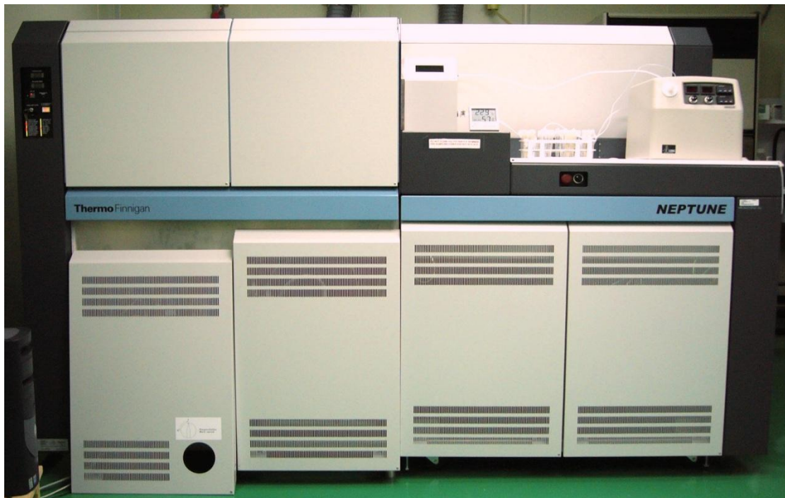
圖2-6. 台大地質系的多頻道感應耦合電漿質譜儀(MC-ICP-MS, Thermo, Neptune)
