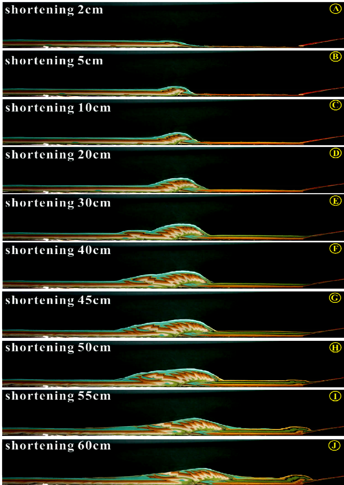
圖 5.12 高度摩擦力侵蝕實驗模擬弧前基磐隱沒系統。
