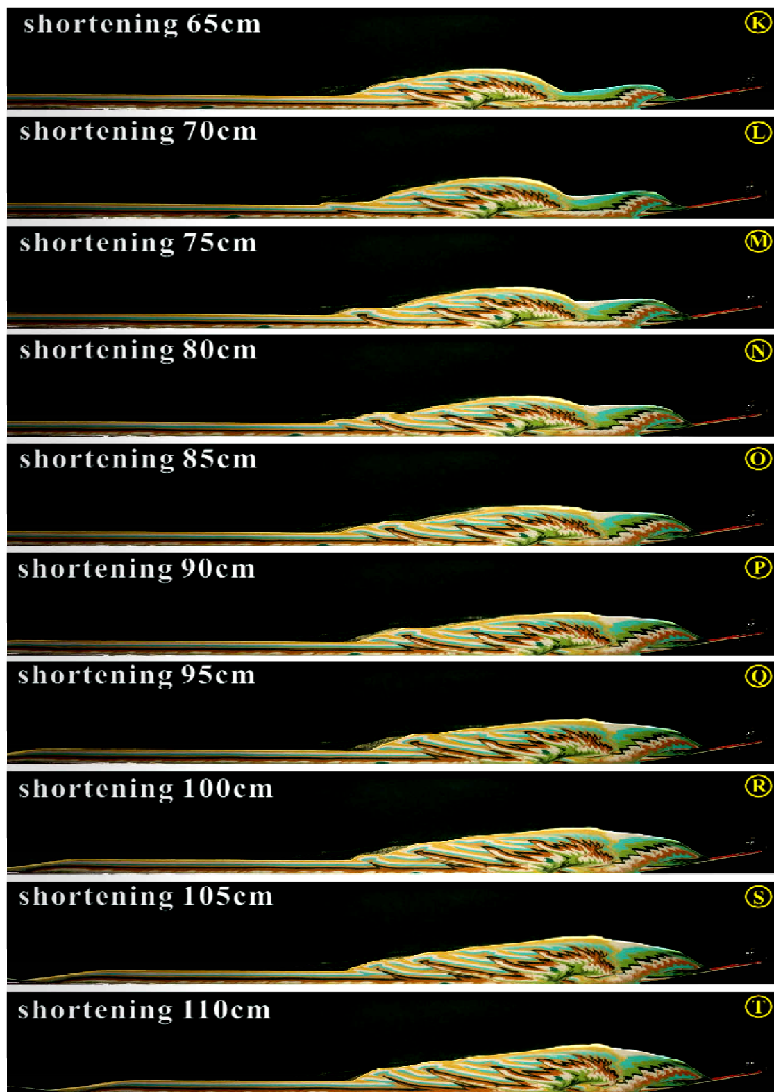
圖 5.11 (續) 高度摩擦力實驗模擬弧前基磐隱沒系統。
