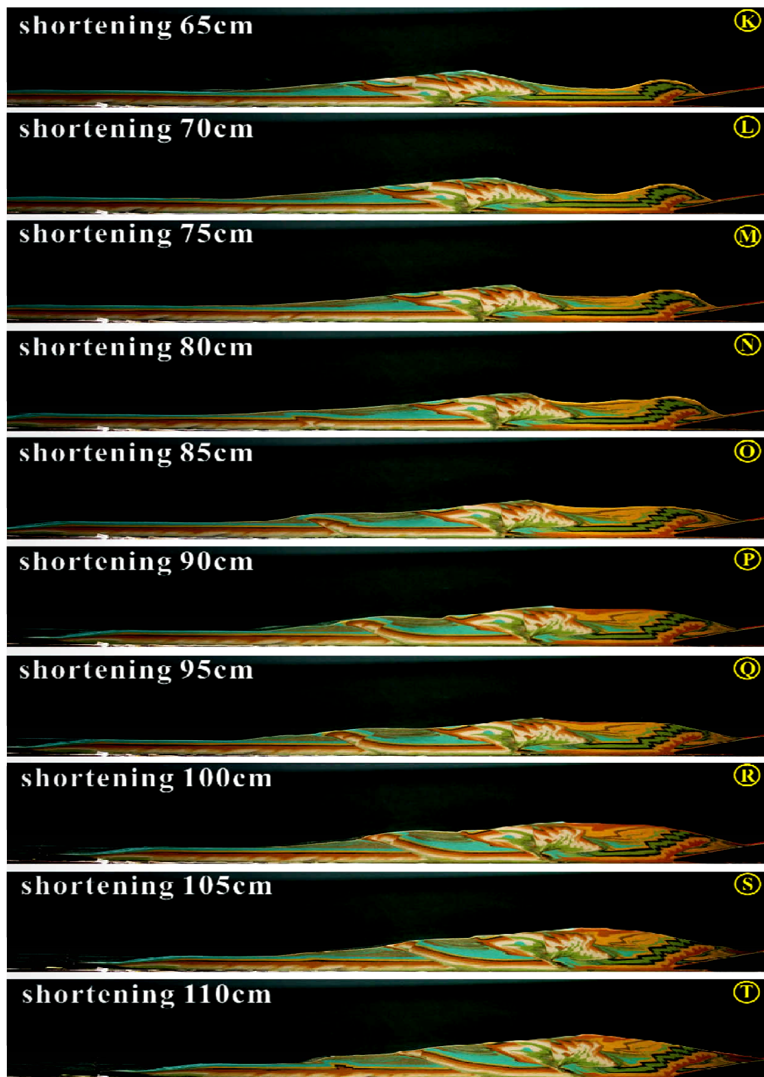
圖 5.12 (續) 高度摩擦力侵蝕實驗模擬弧前基磐隱沒系統。
