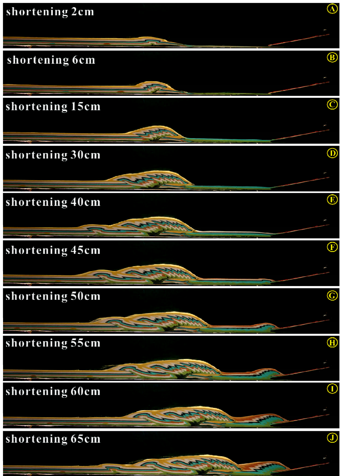
圖 5.9 低度摩擦力實驗模擬弧前基磐隱沒系統。
