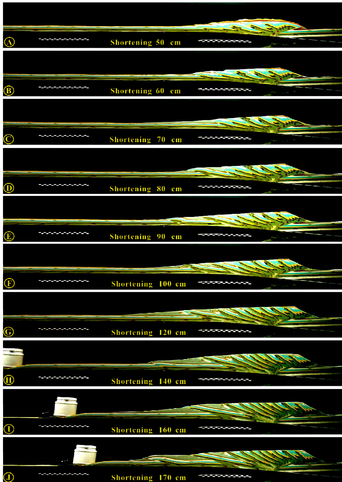
圖 5.4 底部低摩擦力雙向增積楔形體侵蝕砂箱實驗。
