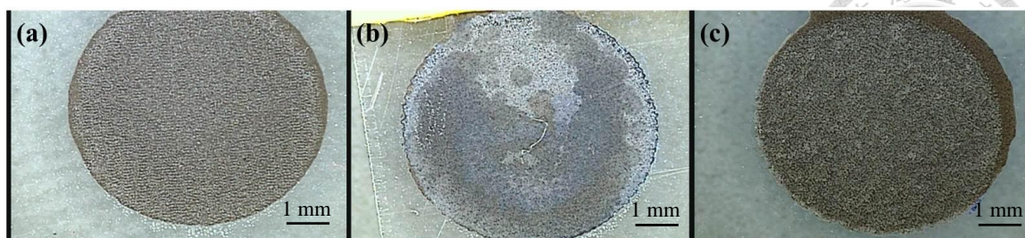
圖 4-1 修飾電極之光學顯微鏡圖：(a) 葡萄糖氧化酶以 30 mm/s 噴墨速率噴塗在碳膠電極上；(b) 葡萄糖氧化酶以 30 mm/s 噴墨速率噴塗在普魯士藍碳膠電極上；(c) 葡萄糖氧化酶以 8 mm/s 噴墨速率噴塗在普魯士藍碳膠電極上
