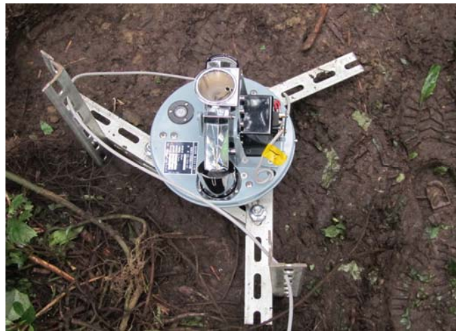
圖 3.12 雨量計基座設置圖
