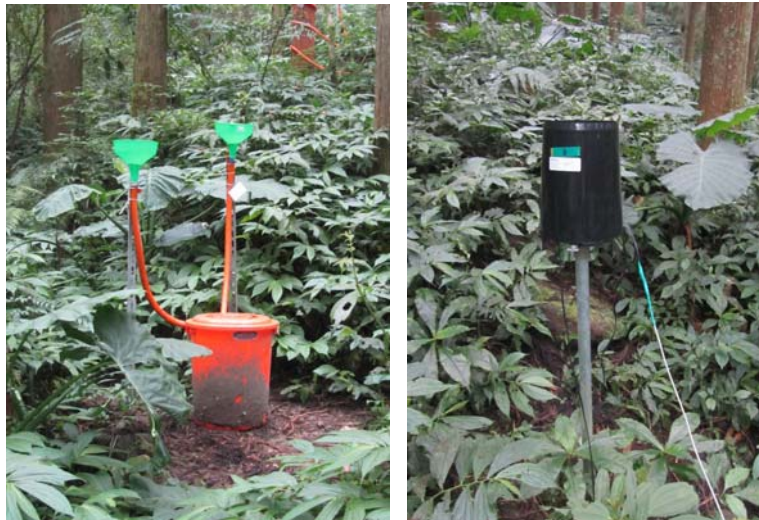
圖 3.10 穿落水裝置圖 (左：水桶，右：雨量計)
