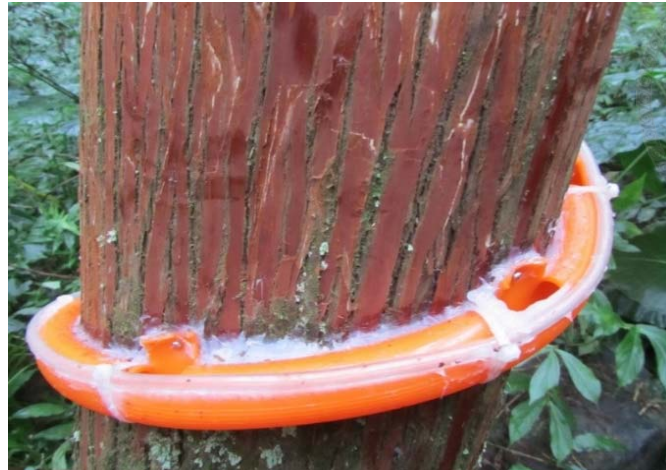
圖 3.11 幹流水塑膠水管纏繞及裝置圖
