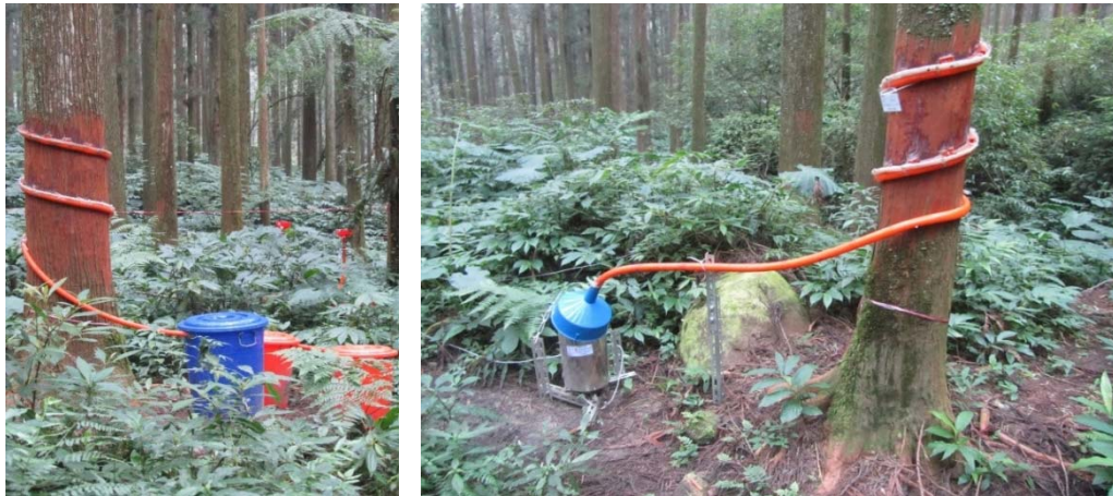
圖 3.14 幹流水承接裝置圖（左：水桶，右：雨量計）
