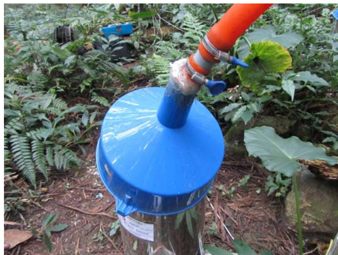
圖 3.13 幹流水雨量計連接示意圖
