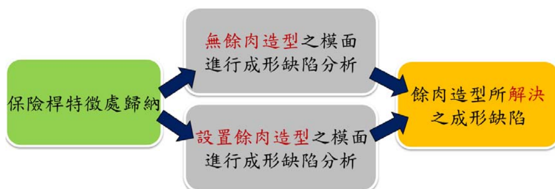
圖 4.4 保險桿餘肉造型歸納流程示意圖
