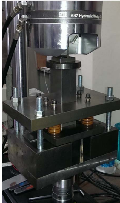
圖 2.54 實際 U 形帽狀引伸成形試驗
