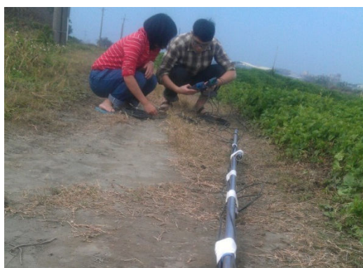
3.6a. 黏貼溶氧感測器在不同深度
