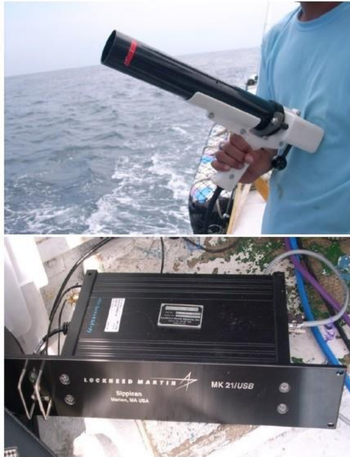
圖 2-5 XBT 儀器示意圖。上圖為 XBT 發射筒，下圖為 XBT 接收器。將 XBT 的探針頭投入海中時，可即時算出海水聲速。
