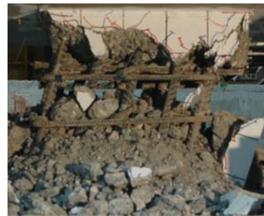
(c) 點“2”之試體破壞照片 [Drift Ratio 為 14.9%]
