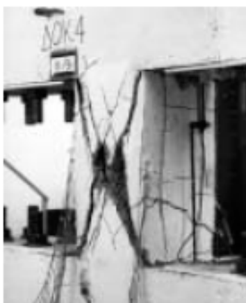
圖 3-34 Moretti and Tassios 短柱試驗破壞模式[25]
