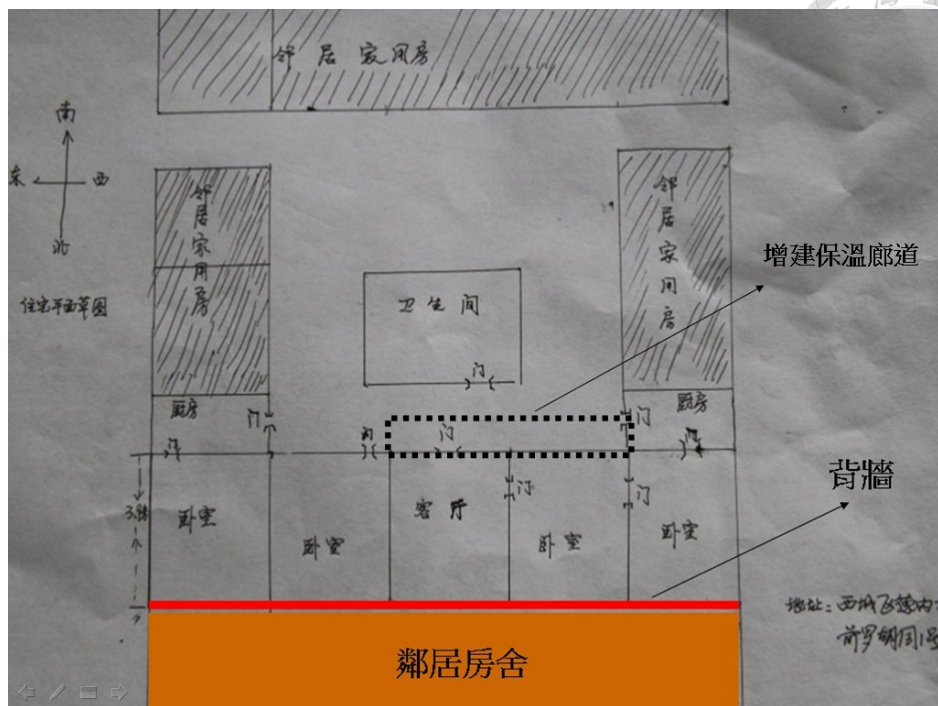
圖 三十二：根據杜香泗先生的作法，他預計在客廳室內空間再延伸到公共過道間設計一隔熱保溫的廊道。（杜香泗繪製，陳婉寧重製）
