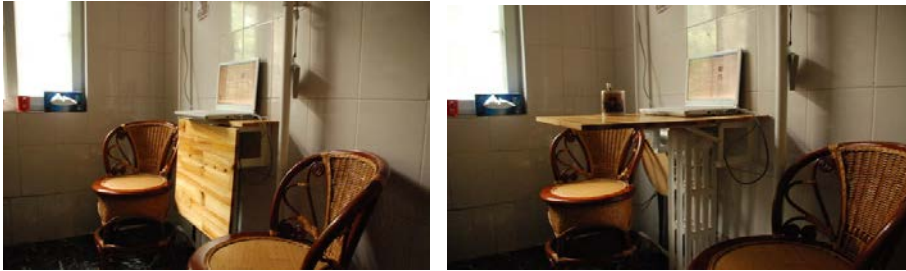
圖 二十六：折疊式餐桌的設計。利用既有的暖氣支架做支撐，再疊加一個折疊式桌板使用，產生一個一兼二顧的複合空間。
