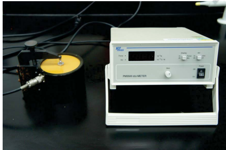
圖 3.14 d_{33} Meter(國衛院醫工組提供)用於量測壓電材料之壓電應變常數
