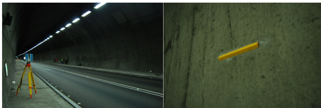
圖 4.11 實驗現場影像。(a)實驗現場 (b)標準變形模擬物
