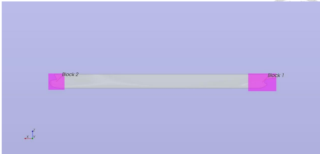
圖 3-22、有自由液面裸船阻力試驗模擬艏艉加密側視圖
