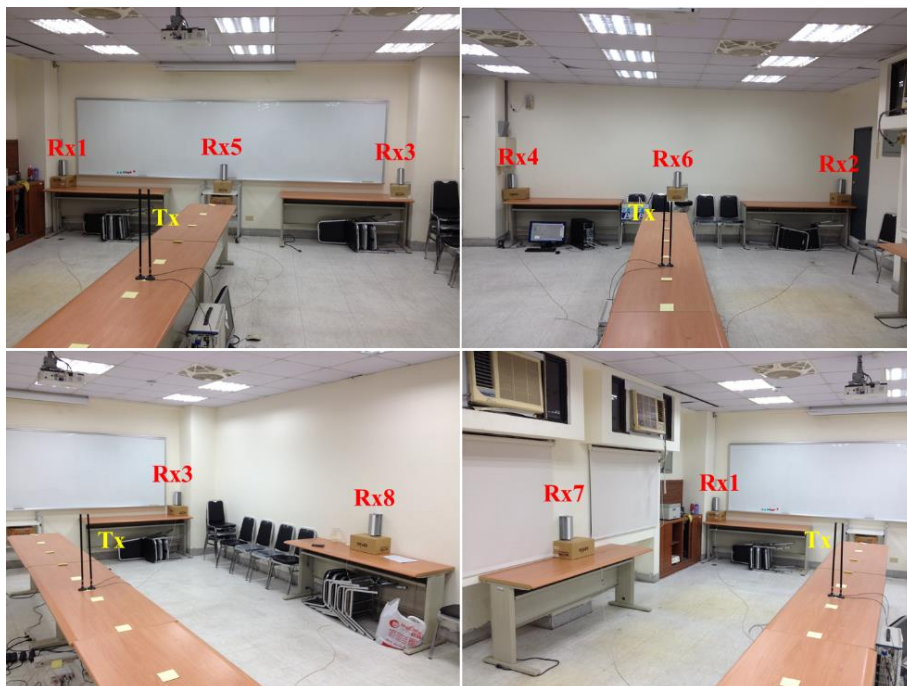
圖 6.3 電機二館 504 討論室現場試驗設置圖
