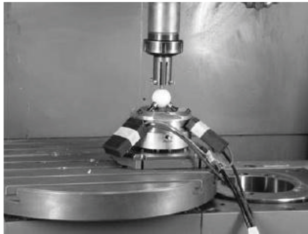
圖 1-2-12 R-test 裝置架設圖[16]
