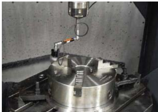
圖 1-2-11 以雙球桿進行幾何誤差量測[13]
