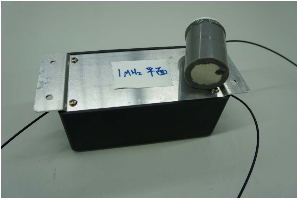
圖 3.1 1MHz 平面式超音波換能器及其匹配電路盒
