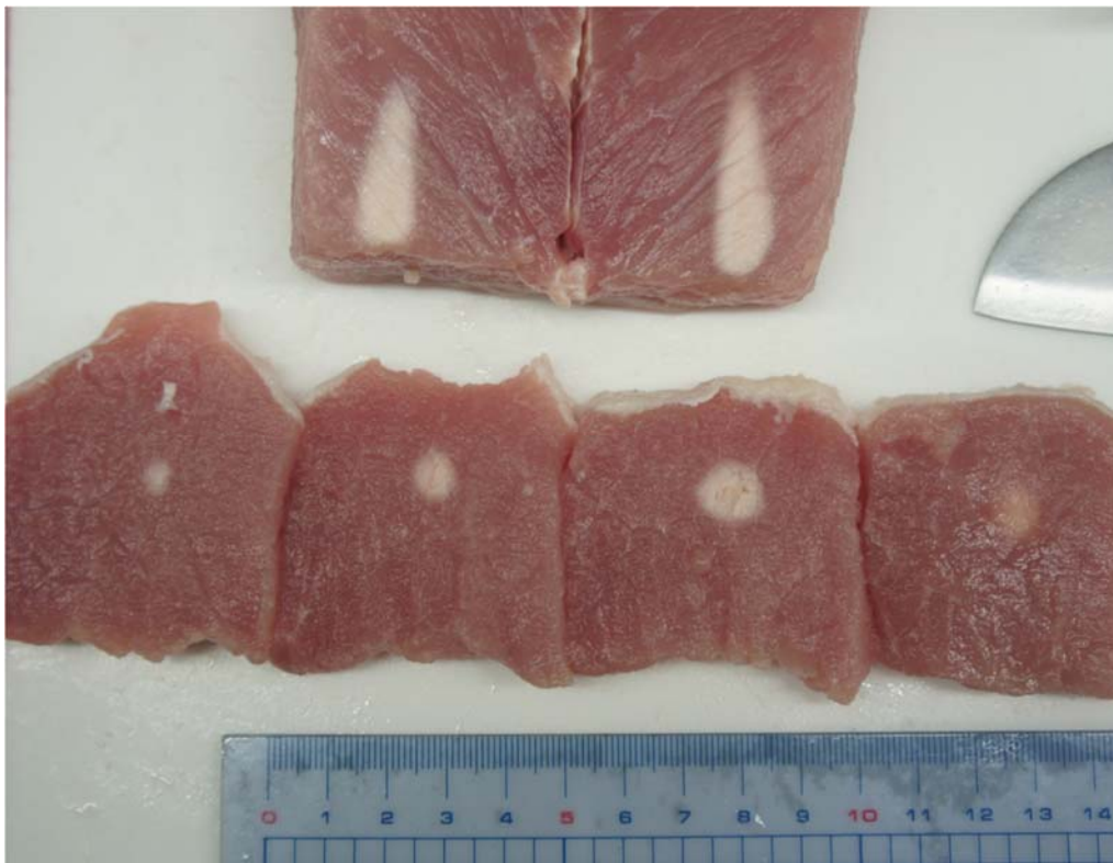
圖 3.3 1MHz 平面式超音波換能器對豬肉組織的燒灼區域
