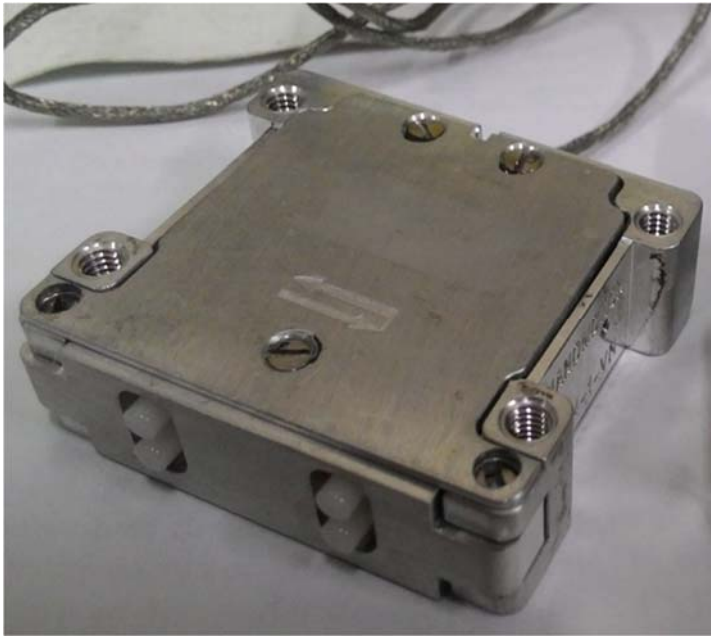
圖 3.8 Nanomotion HR4-U 型超音波馬達及其作動方式
