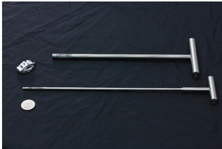
圖 2.17 版本四原型加工成品(包含椎間籠、內轉桿、外轉桿)
