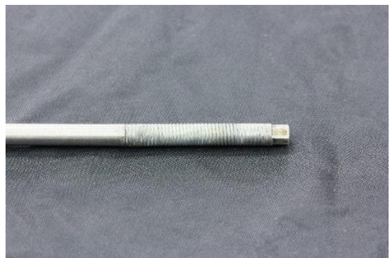
圖 2.22 版本四原型內外轉桿加工成品彈簧連接處
