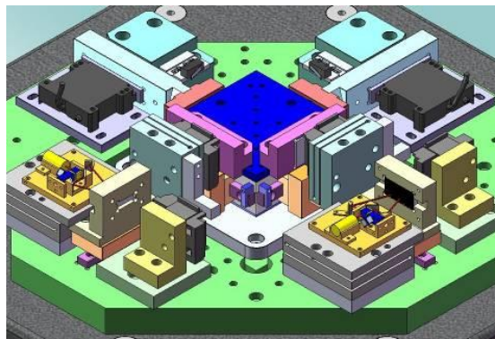
圖 2.4 結構對稱且符合阿貝原則之共平面平台
