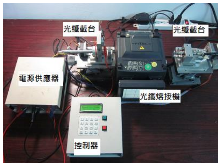
圖 5.10 光纖熔接設備
