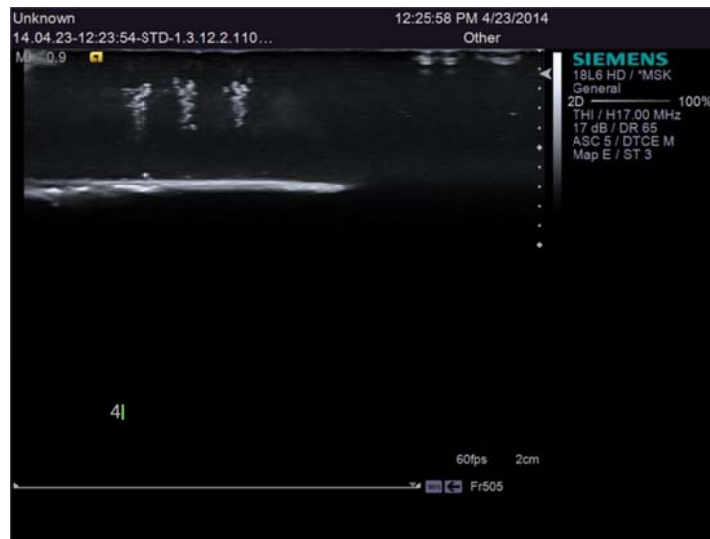
圖 2-9 仿體實驗 4 號標記處超音波影像圖。施打超音波完成後，將蛋白仿體取出水缸，送至台大醫院復健部超音波室，使用 Siemens Acuson S2000 US System 及 18MHz 探頭對各標記點做超音波影像的拍攝。
