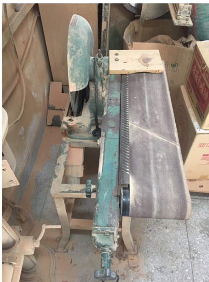
圖 10. 以電動砂磨機進行砂磨作業
