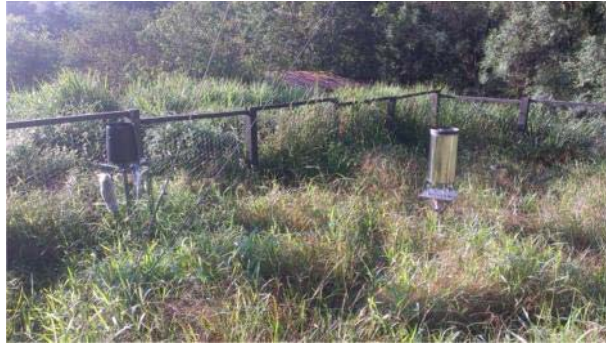
圖 2.3 DAVIS 傾斗式雨量筒及福山試驗中心設置的雨量筒
