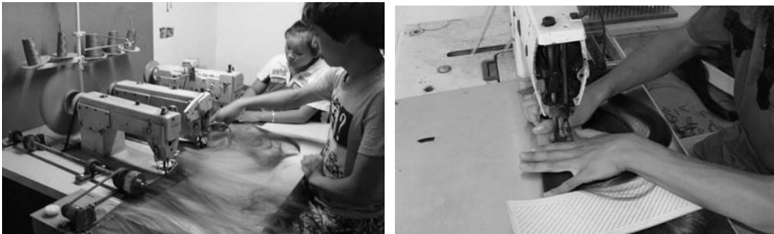
▲圖 4-5、4-6：假髮製作過程。左為排髮機，右圖以頭皮機將假髮車縫至仿真頭皮上。 9
