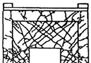
(b) 上方水平牆段，裂縫發展分布在垂直牆段上方[3]
