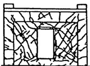
(c) 裂縫直接由施力端延伸至開口下方幾何不連續處[3]
