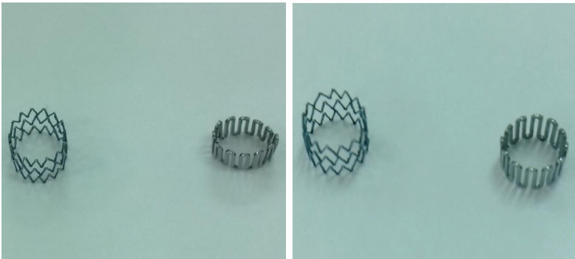
圖 4-15 雛型品置於特定溫度水中並施加外力產生變形(上)；兩血管支架雛型品於 37°C(左下)及 66°C(右下)時回復情形
