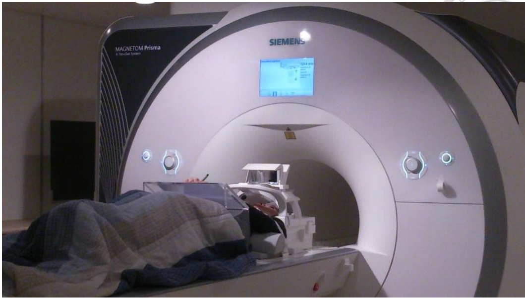
圖 3-3、實驗工具-3T 磁振造影儀、桌子、反射鏡
