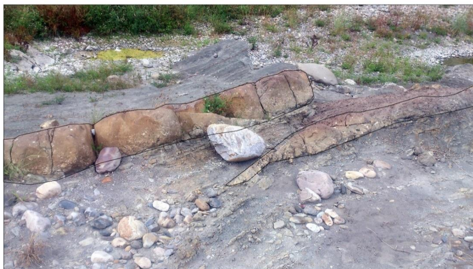
圖 3-1 野外露頭描繪範例之一，圖為 Site 11，描繪過後的露頭可以清楚地揭示其斷層、節理、截切順序與特色。
