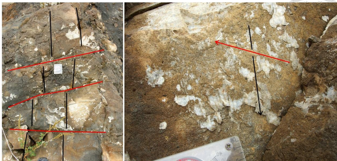
圖 5-9 (左) Site 4 斷層截切關係。1a 期斷層面 (老, 黑線) 被 2b 期斷層面 (新, 紅線) 切過, 其中 2b 期是沿已存弱面再滑動。
