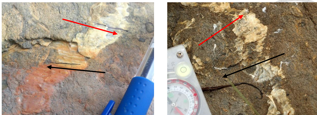
圖 5-14 Site 9 擦痕截切，3a 期逆斷層（新，紅線）蓋在 1a 期正斷層（老，黑線）之上。
