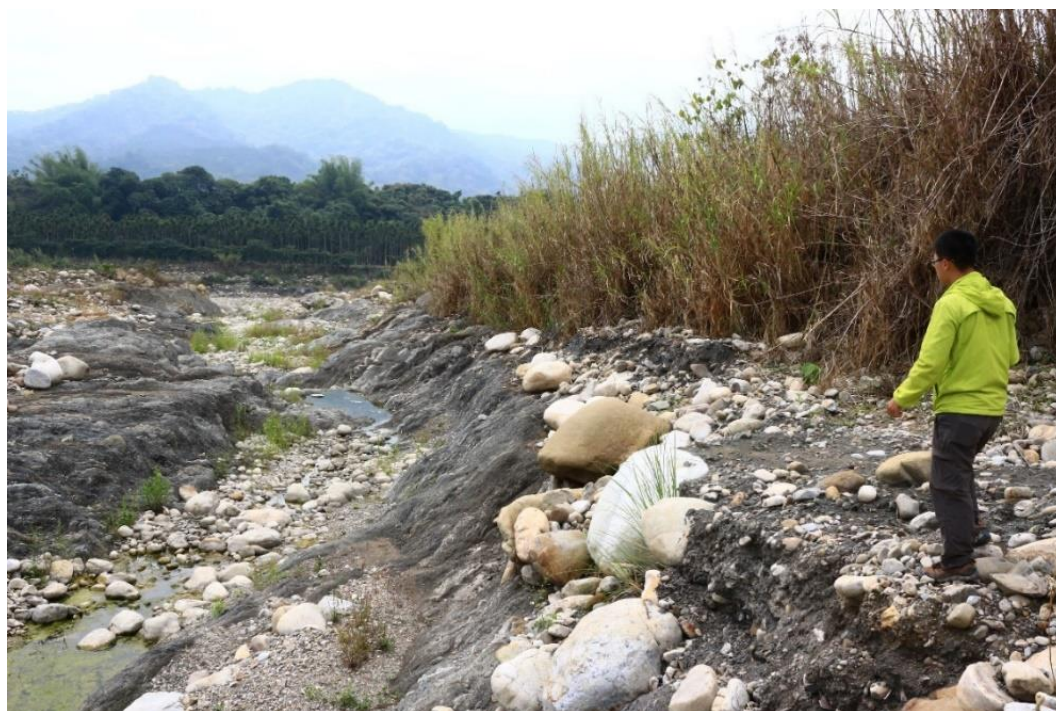
圖 4-21 乾溪龜蒲斷層帶，主要岩性組成為薄砂泥岩互層。
