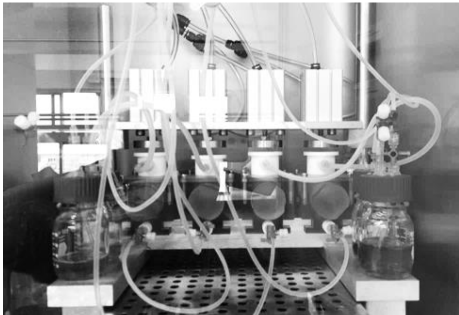
圖 2.1 放置於生物培養箱內的全椎間盤培養系統
