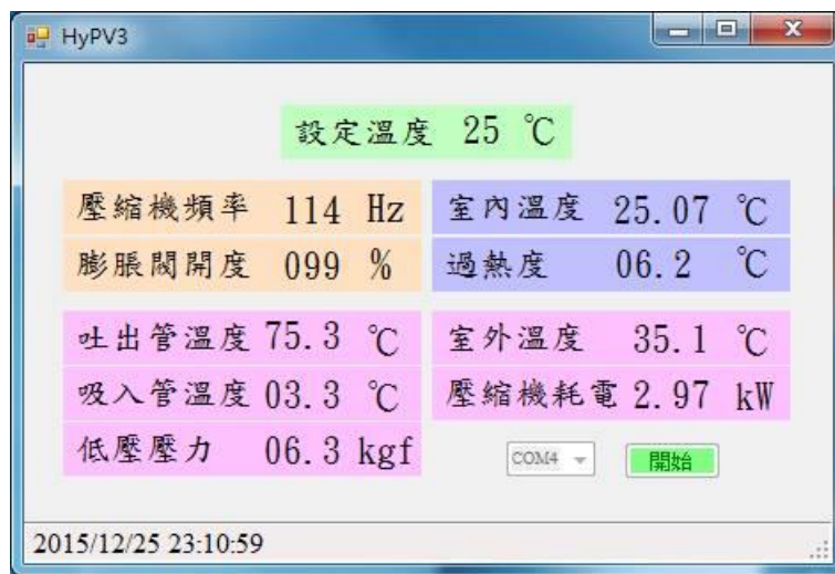
圖 4.1.7 變頻空調監控系統
