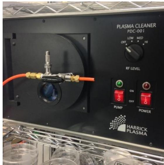
圖 3-7 氧電漿機(PDC-001, Harrick plasma)
