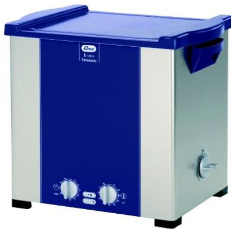
圖 3-2 超音波震洗機(E120H, ELMA)
