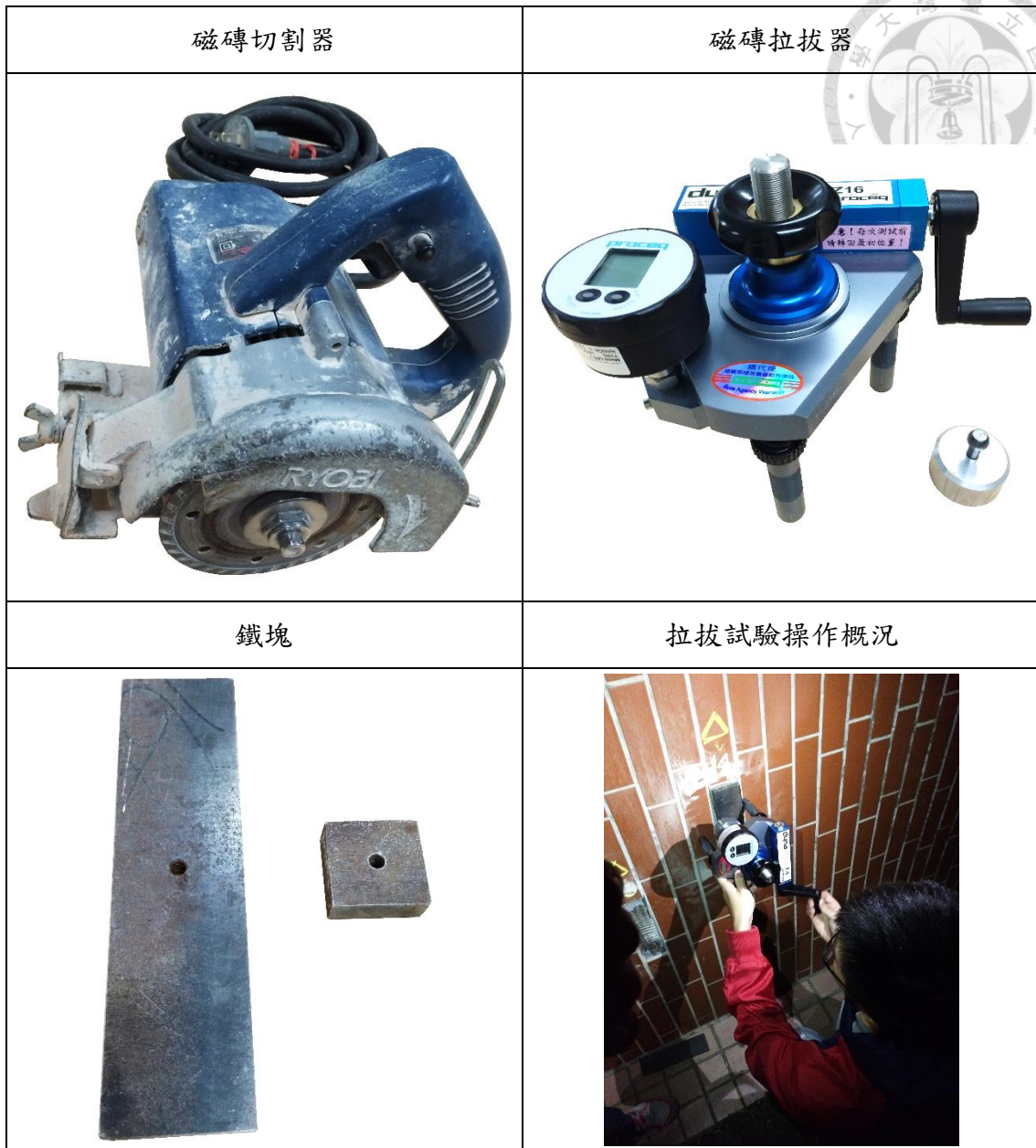
圖 3.3 拉拔試驗設備
