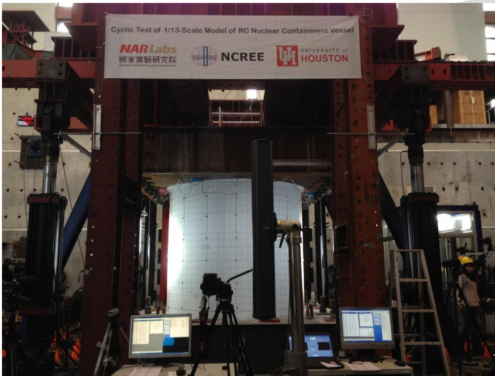
圖 5-7 圍阻體反覆荷重實驗之近照
