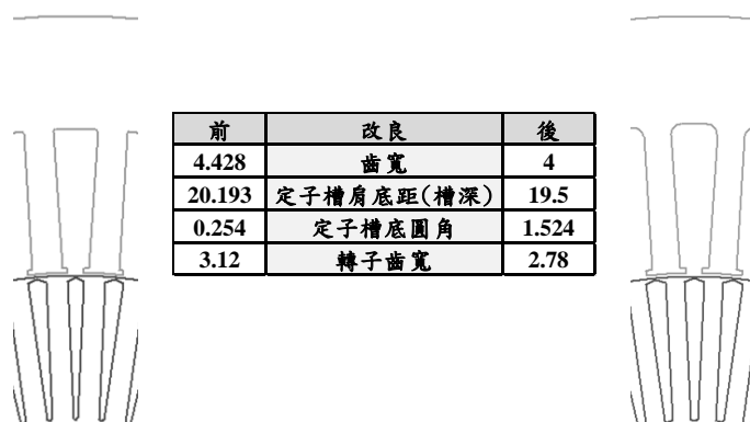
圖 3-48 磁路改良前後之定轉子槽形
