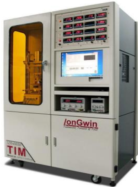
圖 5.6 工研院提供之介面材料熱阻與熱傳導係數量測裝置
