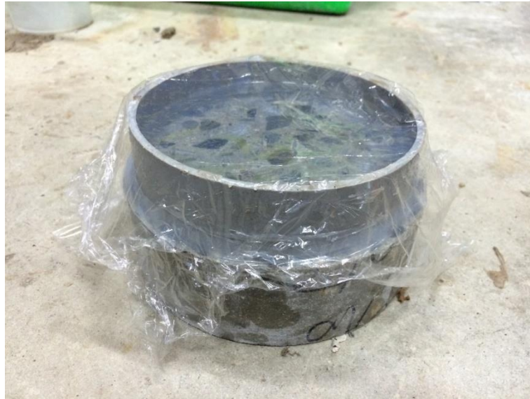
照片 3-15 貯鹽試驗試體架設狀況
