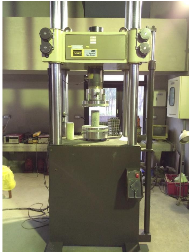
照片 3-7 MTS 萬能材料試驗機
