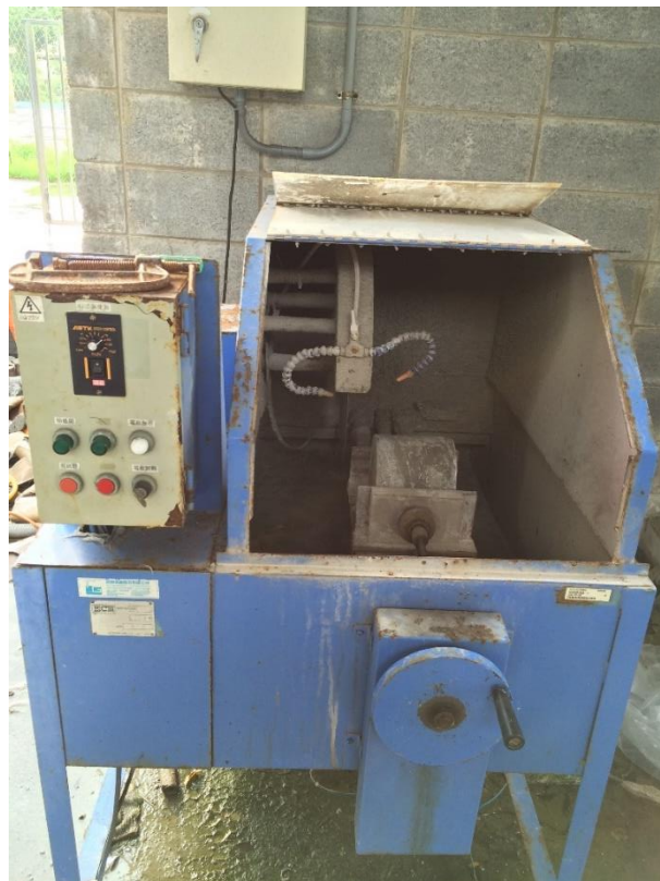
照片 3-6 大型混凝土切割機
