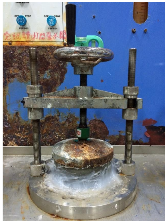
照片 3-14 壓力滲透試體架設狀況
