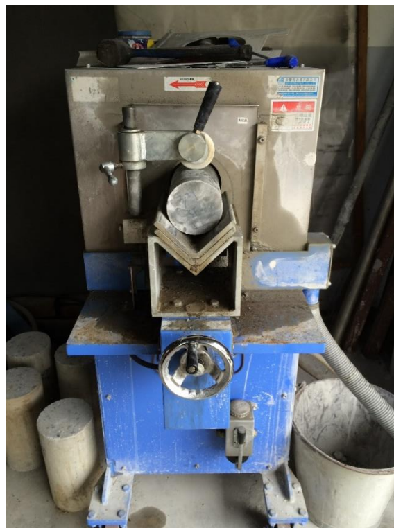
照片 3-4 圓柱試體斷面研磨機
