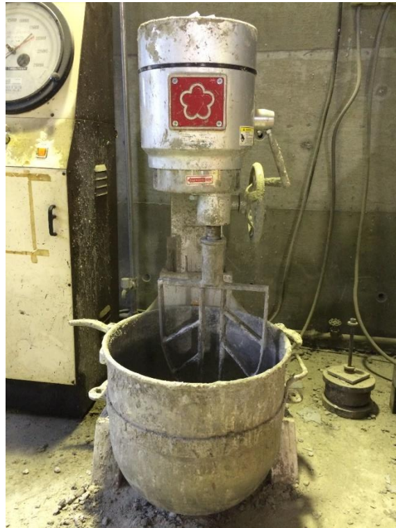
照片 3-1 中型單軸拌合機
