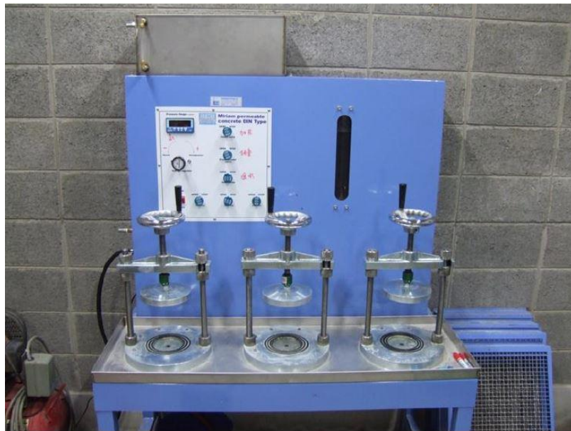
照片 3-8 數位式混凝土透水試驗儀
