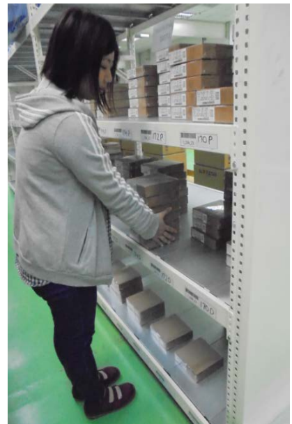
圖 12、第三層料架調降至 114 公分後由身高 160 公分作業人員操作成品搬運示意圖
