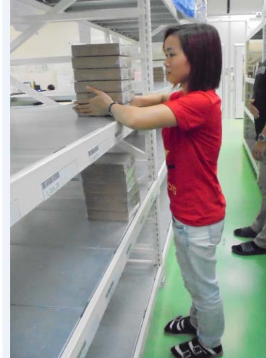
圖 13、第三層料架調降至 114 公分後由身高 160 公分作業人員操作成品搬運示意圖
