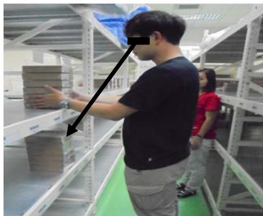
圖 11、第三層料架調降至 114 公分後由身高 173 公分作業人員操作成品搬運示意圖，箭頭顯示其視線被第三層料架阻擋
