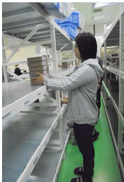
圖 12、第三層料架調降至 114 公分後由身高 160 公分作業人員操作成品搬運示意圖
