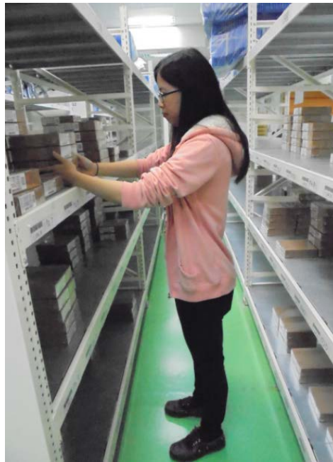
圖 9、身高 163 公分作業人員搬運 第三層料架上之成品示意圖
