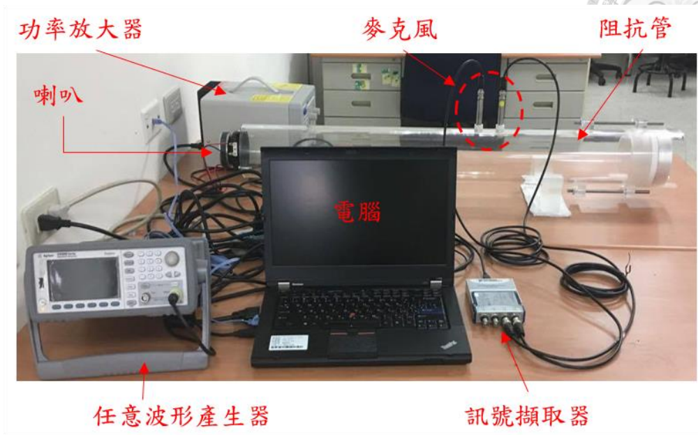
圖 4.12 實驗架設之實際情況
