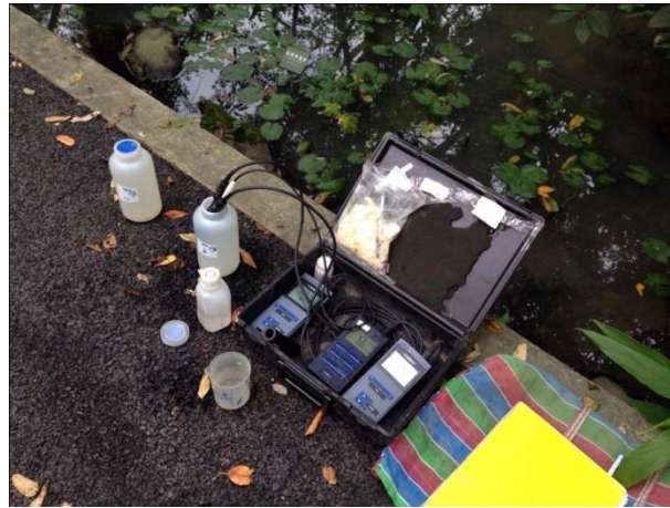
圖 3-12、調查實景一。於一期樣區海綿道路上，以攜帶型儀器檢測水質電導度、溶氧、pH 和水溫。
