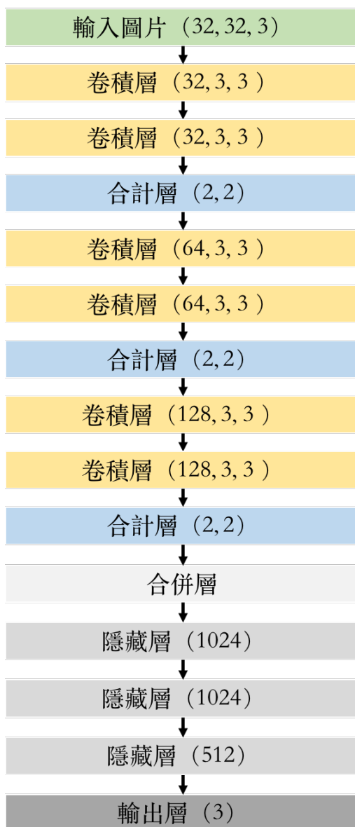
圖 4.6: 影像辨識模型架構圖
