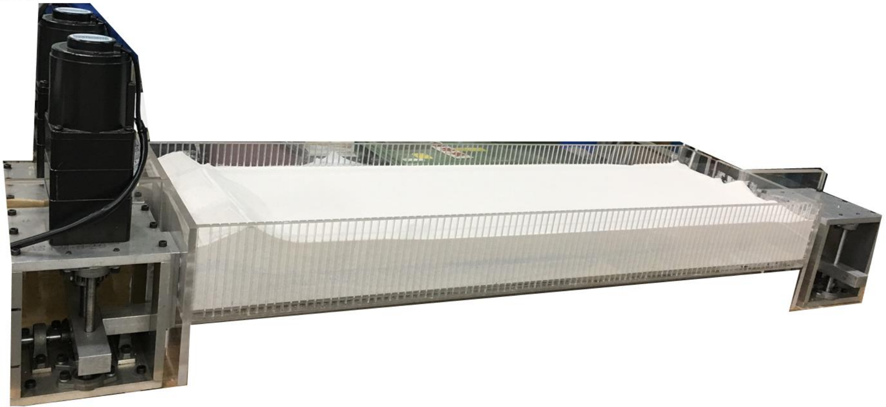
圖 3.2 砂箱模型照片，試驗區域尺寸為 100 cm(長)×30 cm(寬)×10 cm(高)，高度則視所鋪設砂層厚度而定
