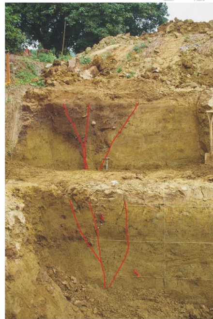
圖 2.2 新化斷層槽溝開挖剖面，可觀察出近地表陷落的負花狀構造(林啟文 et al. 2007)
