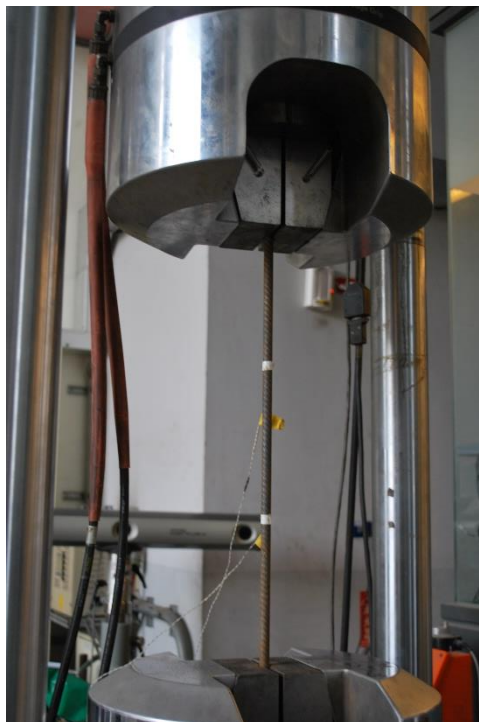
圖 4-2 鋼筋拉拔試驗
