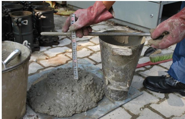
圖 3-8 混凝土坍流度試驗
