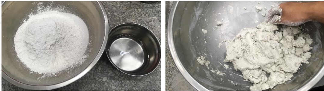
圖 5.4 石英砂及高嶺土之原料（左）及拌合情形（右）
