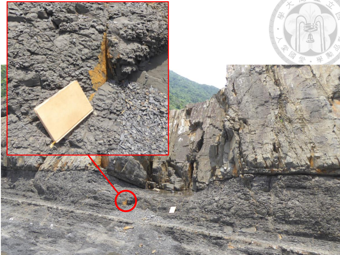
圖 4.4 硬頁岩中的節理及鏽染情形
