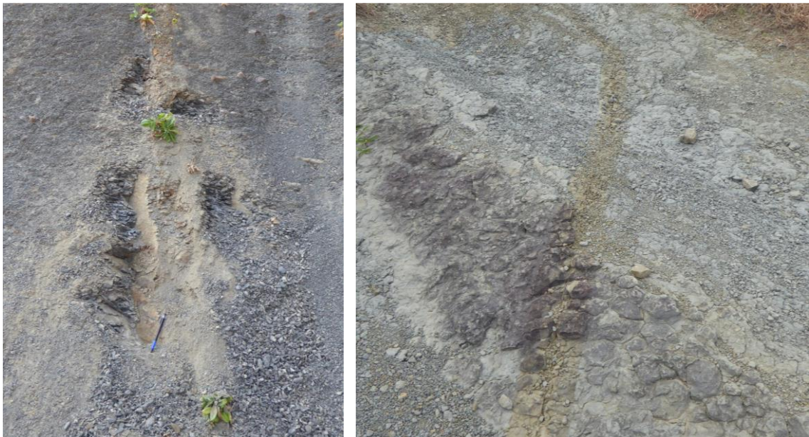
圖 4.8 頁岩中節理之生長植物及鏽染現象
