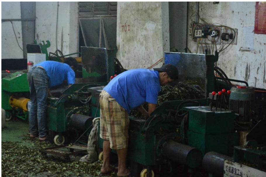
圖 13 豆腐機，圖中的工人正在將剛壓完一次的茶葉解塊。豆腐機較蓮花機節省力氣和人工，但因為成品賣象較差，故通常用於價值較低的飲料茶原料。
