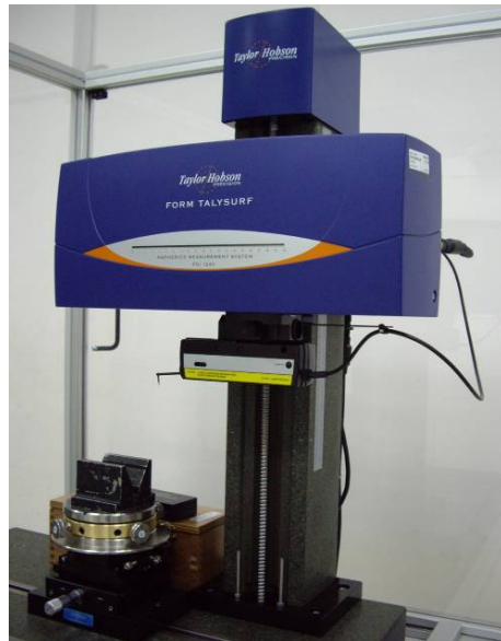
圖 3-24 非球面表面輪廓儀 (台大精密量測實驗室)
