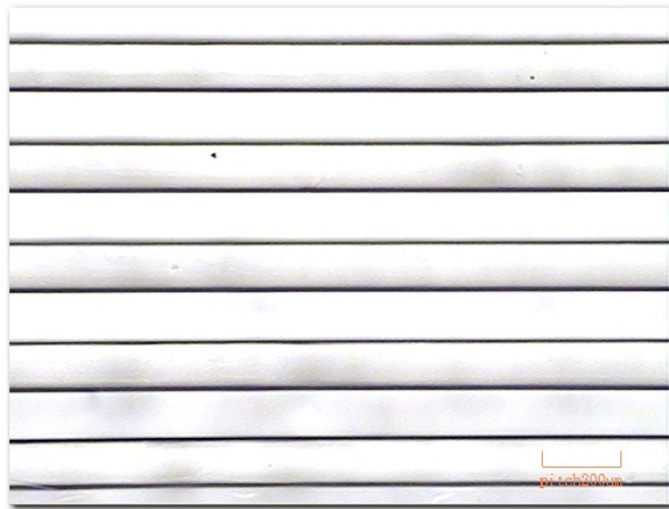
圖 4-5 柵欄結構(grating)軟模 寬度：135 \mu\text{m} ，間距：135 \mu\text{m}
