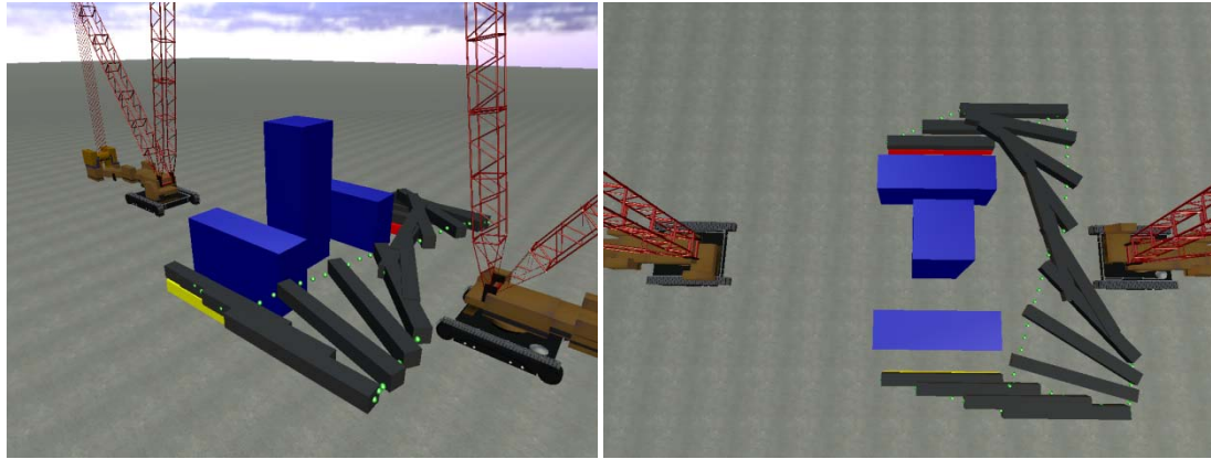
圖 6.9 實驗二全障礙物不可通過時之替代吊裝路徑二
