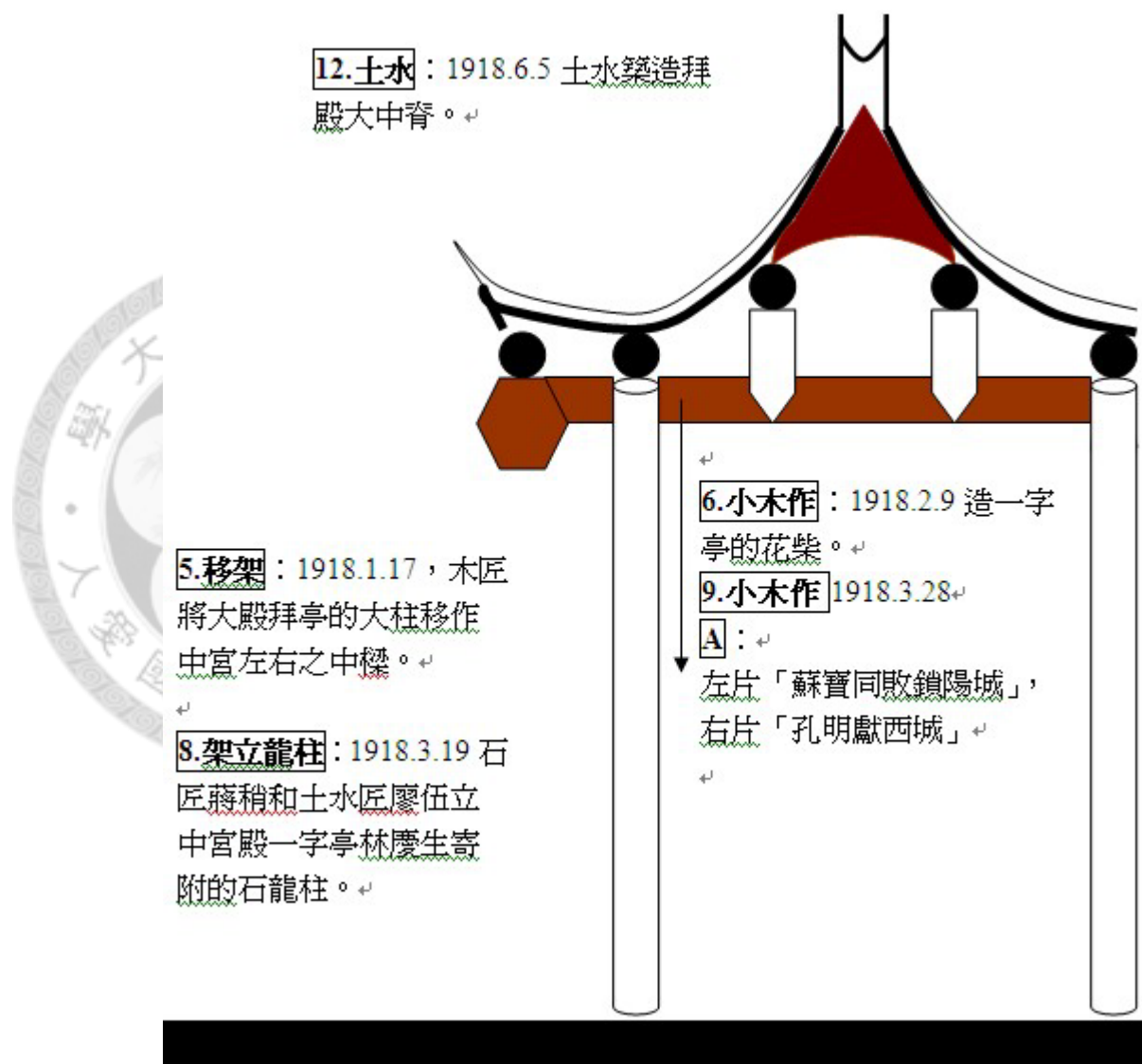
圖 5 〈大殿工序斷面圖〉(二)：拜殿部分
