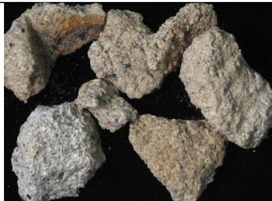
圖四- 84：水泥沙漿，標本編號 S15，洪菁敏攝，筆者裁切
