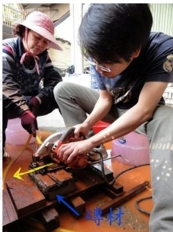
圖一- 3：將磚材固定於木製基座上，將砂輪切割機沿磚材表面做短軸方向的切割，如黃色箭頭示意。
