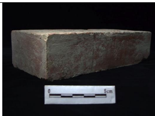
圖三- 26：製磚技術良好，各面都相當平整，轉角銳利垂直，標本編號 S65-001
