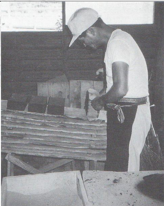
圖四- 6：取起多餘的黏土（引自《日本煉瓦史の研究》，p179）
