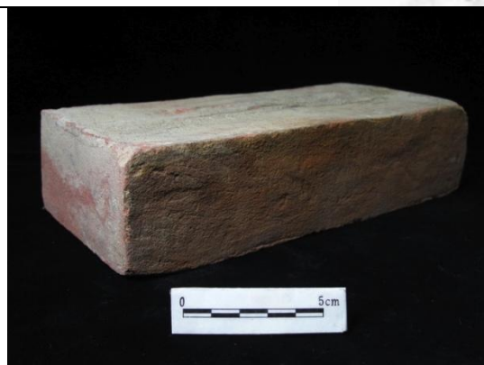
圖三- 16：製磚技術較蒟蒻磚好，但仍殘有手造的感覺，惟橫面頗為平直，標本編號 S15-008
