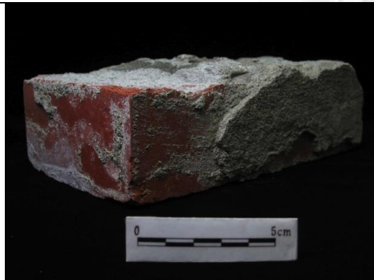
圖四- 89：TR 商標紅磚含水泥沙漿，標本編號 S15-009
