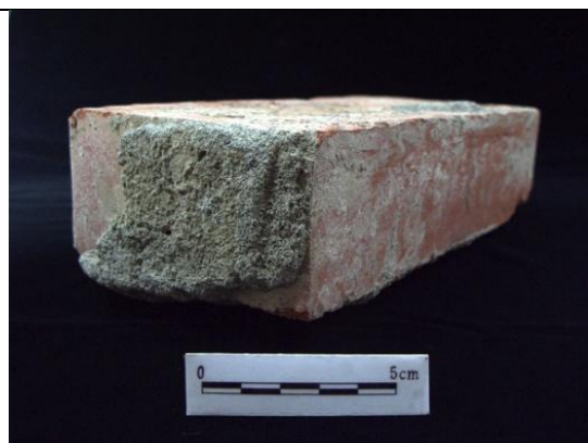
圖三- 27：S 磚結構所使用的水泥黏著劑，品質很好，硬度及黏著性都很高，標本編號 S65-001
