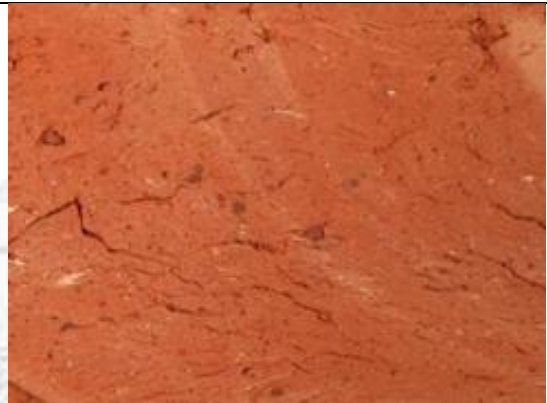
圖四- 76：S 商標紅磚切片斷面，標本編號 S15-009
