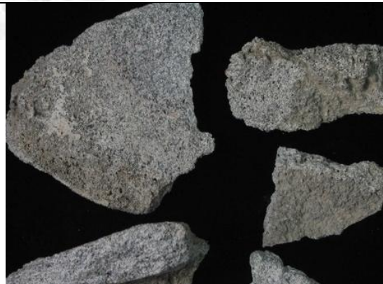
圖四- 90：水泥沙漿，標本編號 S66，洪菁敏攝，筆者裁切
