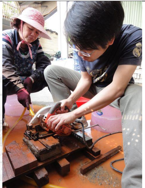
圖四- 18：切片的過程，必須一直加水降低鋸片的溫度（劉若敵攝）
