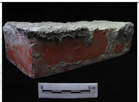
圖三- 33：TR 磚結構所使用的水泥黏著劑，品質很好，硬度及黏著性都很高，標本編號 S66-009
