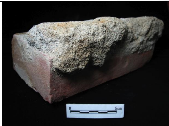
圖四- 83：二爪磚含水泥沙漿，標本編號 S15-014
