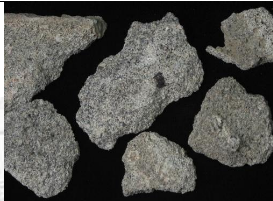
圖四- 88：水泥沙漿，標本編號 S65，洪菁敏攝，筆者裁切
