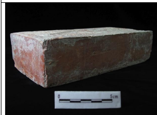
圖三- 32：製磚技術良好，各面都相當平整，轉角銳利垂直，標本編號 S66-009
