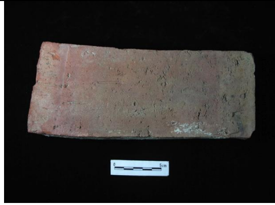
圖三- 10：蒟蒻磚不規整的外型，可見表面有些許直線刮痕，也可見磚體的顏色並不均勻，標本編號 S120-026，洪菁敏攝 80
