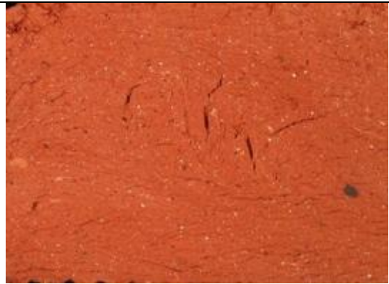
圖四- 74：S 商標紅磚切片斷面放大，標本編號 S15-007
