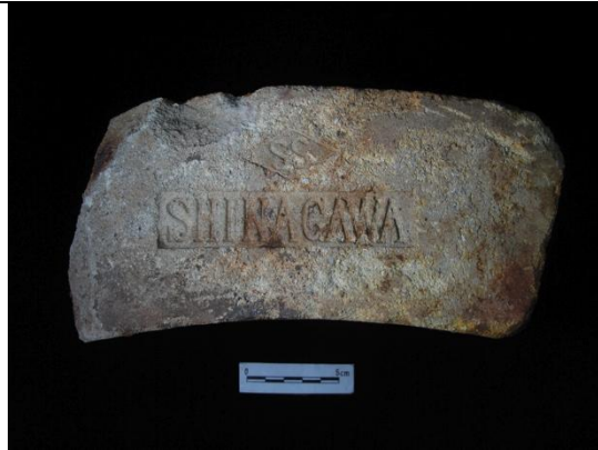
圖三- 34：SHINAGAWA 耐火磚，弧形，並有 SS 字樣，標本編號 TPC-brick-L7-049
