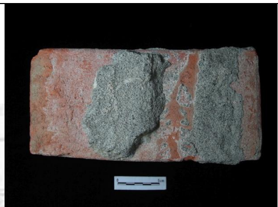
圖三- 21：此種磚造結構所使用的水泥黏著劑，含砂量高，但強度較二爪磚結構使用的高，標本編號 S42-014
