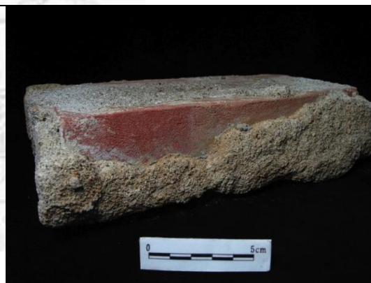
圖三- 17：二爪磚結構所使用的水泥黏著劑，含砂量很高，風化嚴重，標本編號 S15-009
