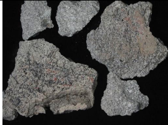
圖四- 86：水泥沙漿，標本編號 S42，洪菁敏攝，筆者裁切
