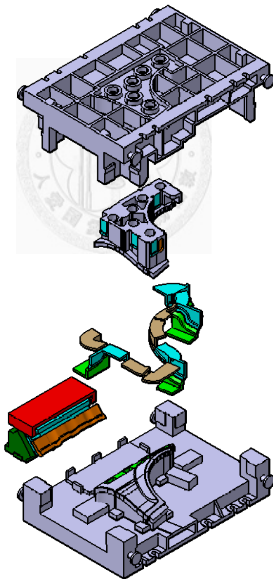
圖 6.59 剪切模具實作成果
