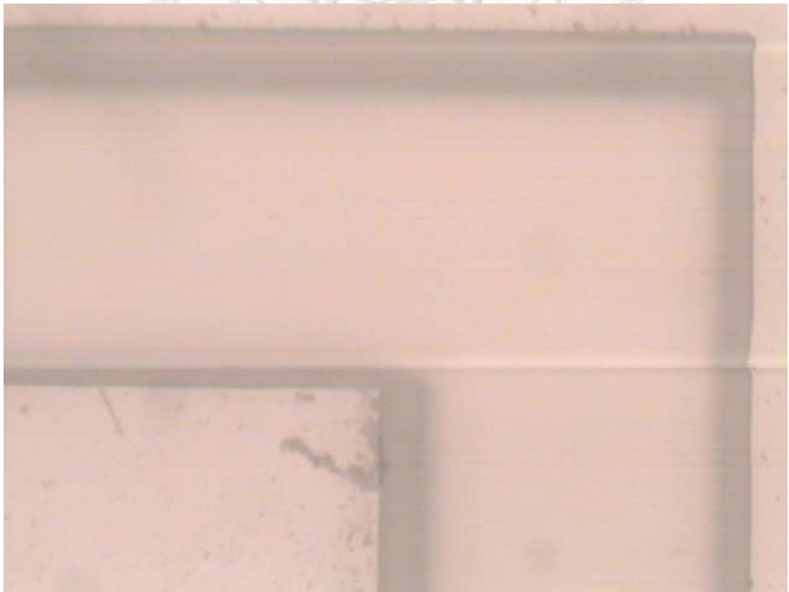
圖 6-12 Z-cut \varphi=90^\circ 之右邊外凸角隅
