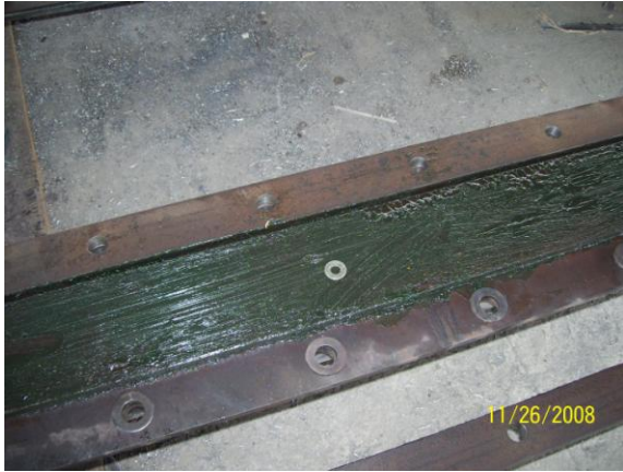
照片 3.1 圍束構件置入核心單元、墊板與 2~3mm 墊片
