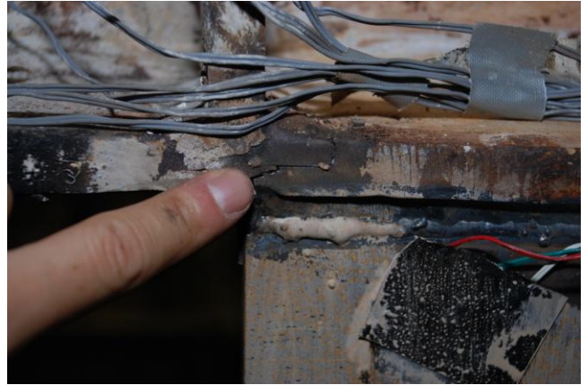
(b) 試體五上端接合板沿梁翼板裂縫密合(+0.025 rad)
