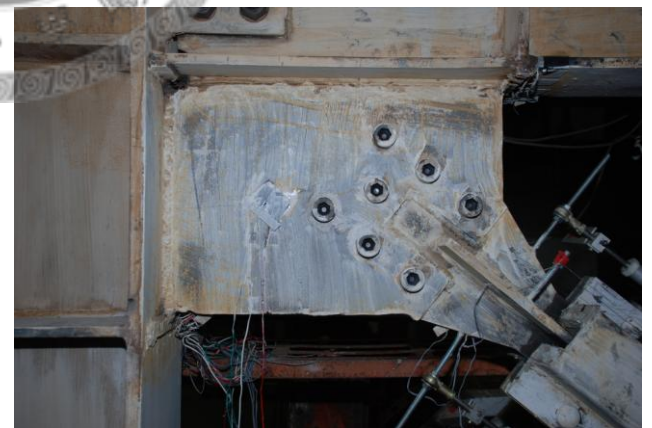
(f) 試體四梁翼板輕微撓曲變形 (-0.02 rad)
