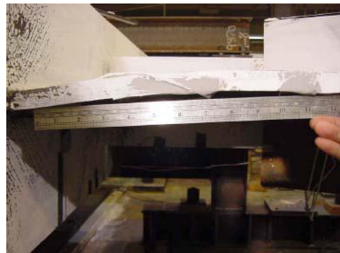
(b)接合板受梁柱夾合挫屈圖
