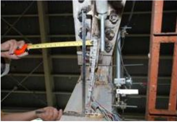
(a) 試體二上端接合板挫屈(下視) (-0.01 rad)
