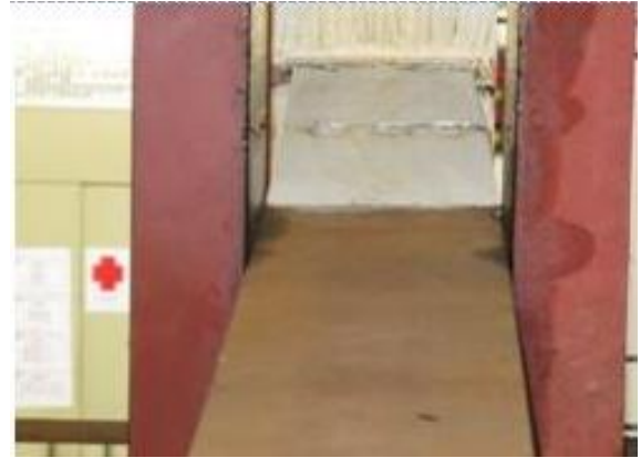
(b) 試體二梁輕微面外變形(-0.01 rad)
