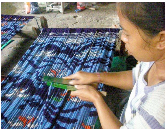
圖3-4 新發展出來的endek織布生產工序「搓染」（ nyatrik ） 。筆者2009年5月12日攝。
