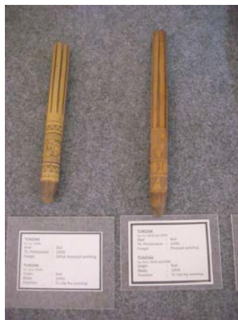
圖2-9 將緯線筵子置於梭子 ( tundak ) 中，即可來回穿梭於上下交錯的經紗之間。筆者2009年6月29日攝。
