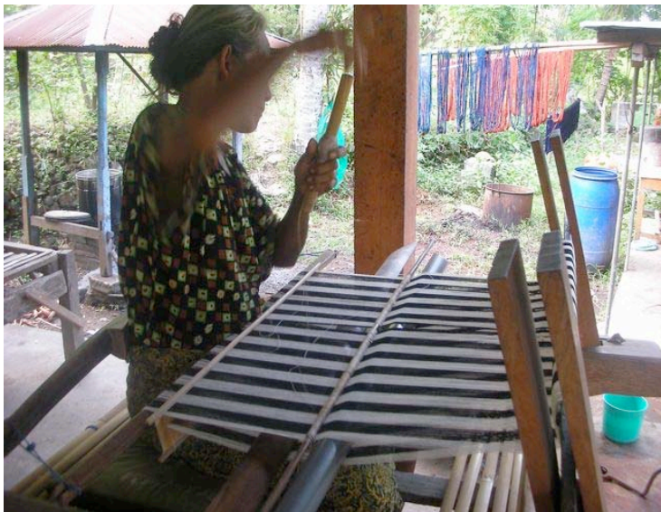
圖2-7 婦女使用水平背帶織布機 ( cagcag ) 示範織布，圖中可以清楚看到竹筓 ( serat ) 與隔棒 ( bumbungan ) 之間看到一根上過蠟的打棒 ( belida )，以及區隔偶線與奇線的綜統棒。筆者2009年5月17日攝。
